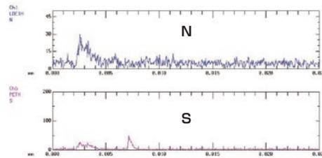
M-Mプロセス Type-SはM-Mプロセスの浸硫酸化層に硫黄成分を濃化したことにより耐焼付き性の向上が期待されます。
